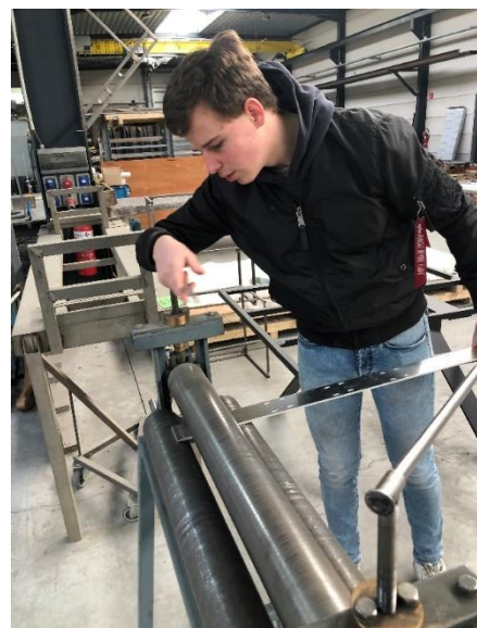
Figuur 81: De plaatwals
